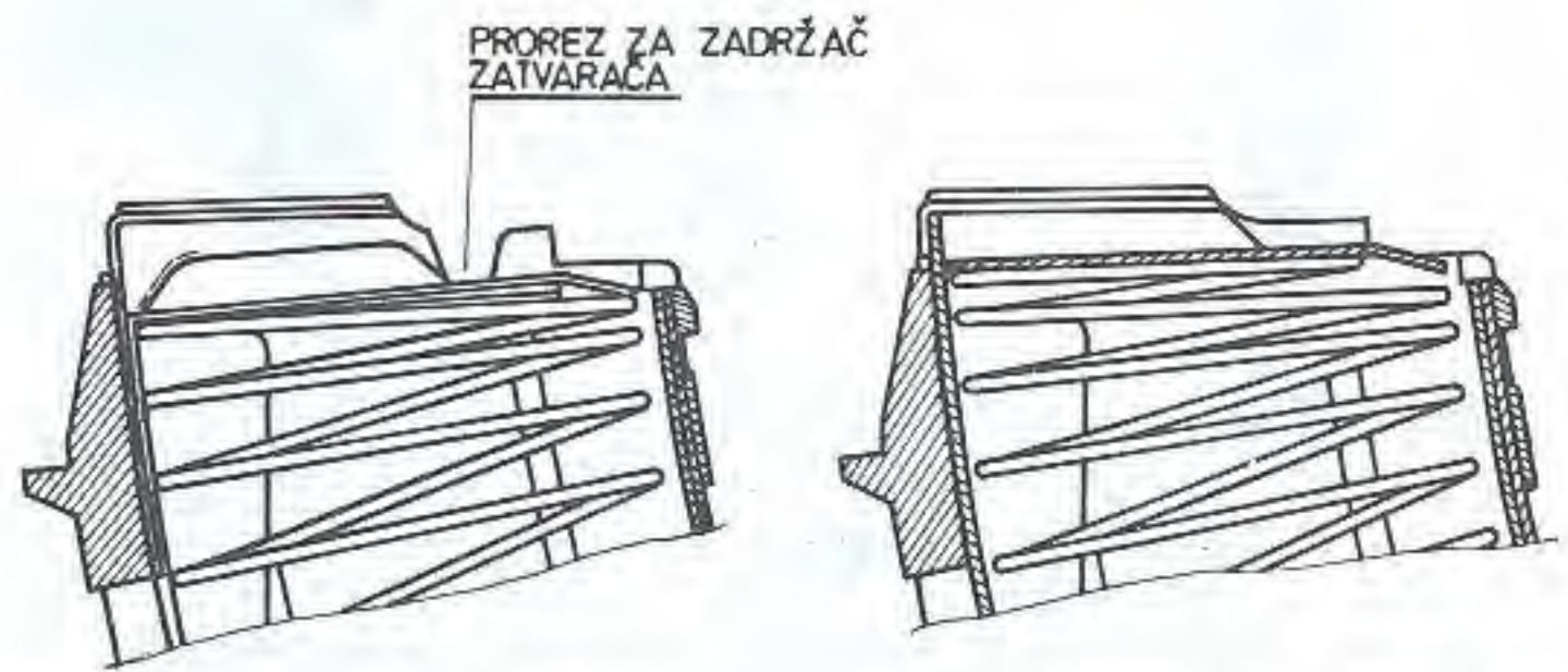
b) Izgled okvira sa leve strane i odozgo kod oružja koje ima zadržać zatvarača
